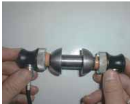
Fig. 17 - Test di calibrazione (ecogramma) per verifica integrità chiodature - Elemento campione integro
