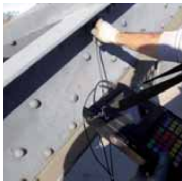
Fig. 16 - Misura Ultrasuoni su chiodature archi
