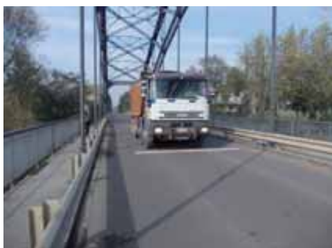
Fig. 23 - Prova dinamica impulsiva – Autocarro zavorato su ostacolo
