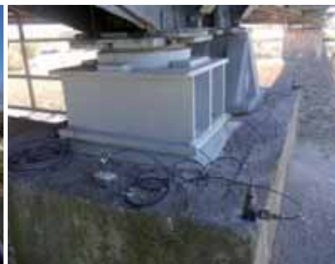
Fig. 34 - Posizioni accelerometriche in sommità della pila
