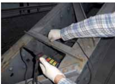
Fig. 11 - Rilievi di spessore
