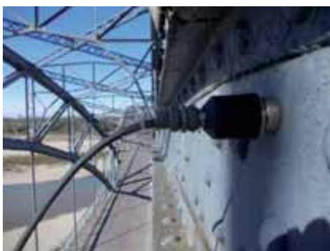
Fig. 24 - Dettaglio di un accelerometro su arco
