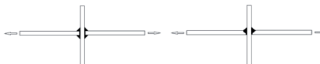
Fig. 11 - Giunti trave colonna. A destra provvisti di piastra di rinforzo, a sinistra privi
