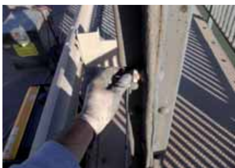
Fig. 10 - Misura Ultrasuoni su chiodature pendini
