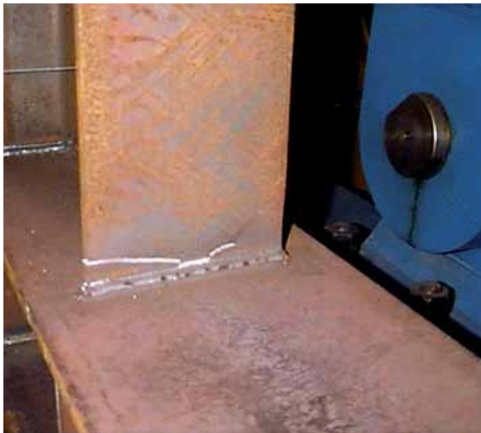
Fig. 14 - Aspetto di un campione di tipo C, al termine della prova. La prova è "a rottura", quindi la rottura non è indice di un difetto, ma è l'esito finale della prova. Eventuali difetti riducono il numero N di cicli sopportati. Se il difetto è nella saldatura, la prova viene eseguita ugualmente e se ne tiene conto nella misura di k_f , e, in ultima analisi, nella identificazione dello \Delta\sigma_c .
