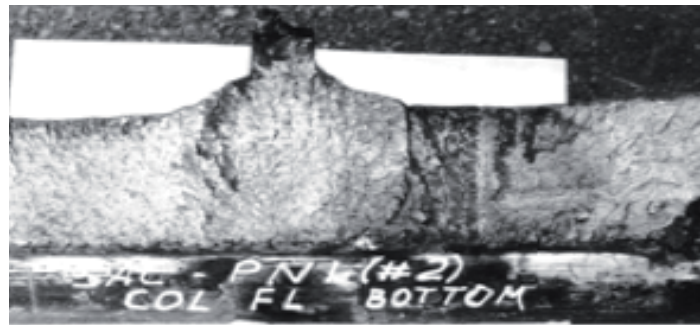
Fig. 16: prova su campioni di saldatura. Ingrandimento della saldatura, prima della prova.
