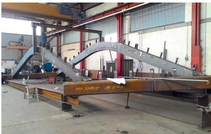
Fig. 11 – Centine del lucernario in fase di assemblaggio
