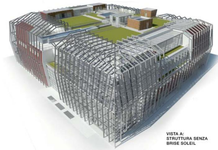
Fig. 10 - Vista 3D carpenteria metallica della facciata
