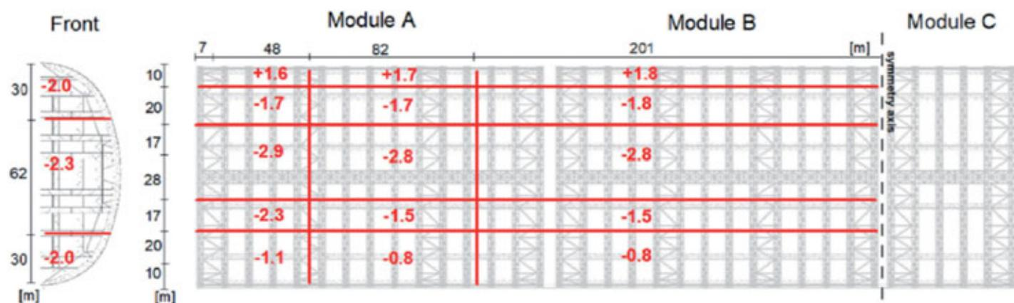
Fig. 24 - Pressioni statiche effettive del vento (kN/m<sup>2</sup>)
