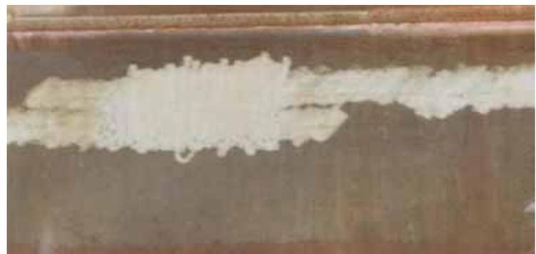
Fig. 6 - Asportazione di difetti lineari mediante molatura
