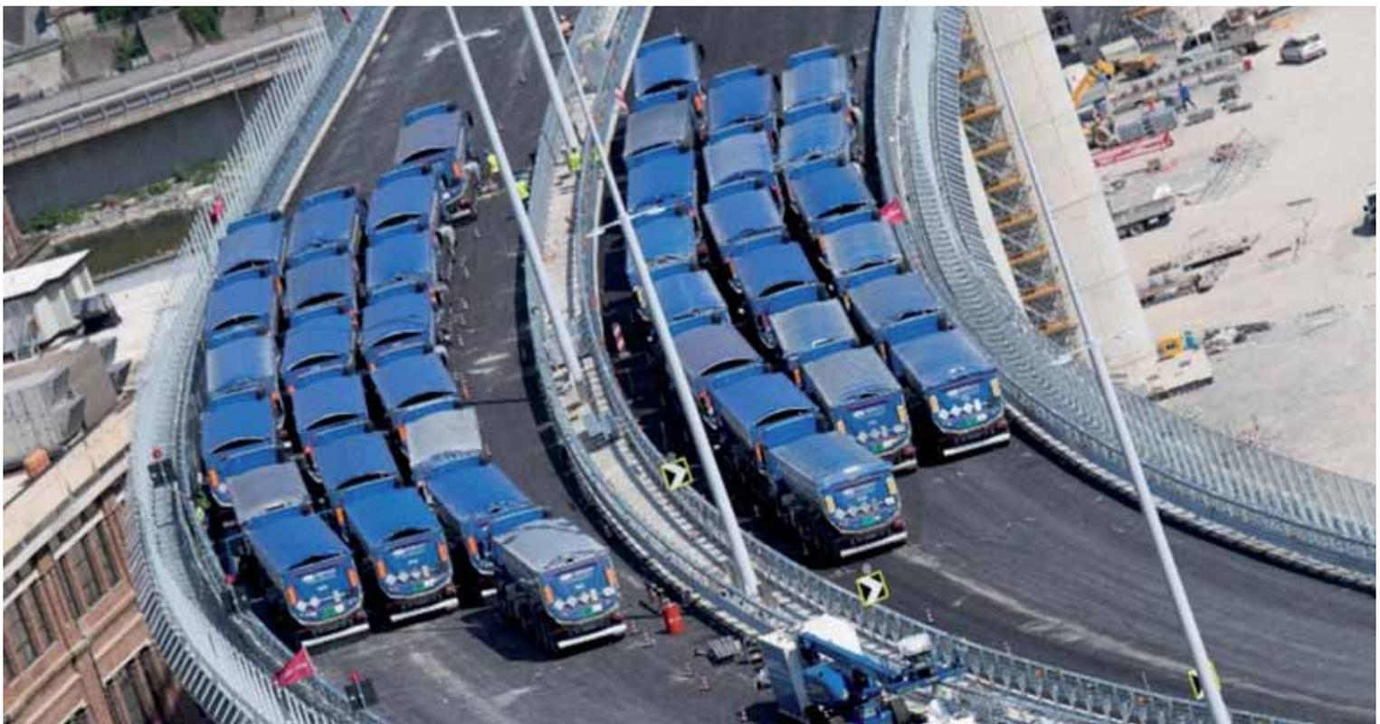
Fig. 22 - Configurazione dei camion in cantiere, per momenti flettenti negativi
