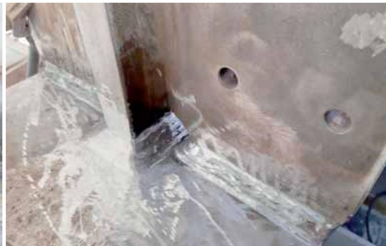
Fig. 45: Preparazione delle saldature al grado P3
