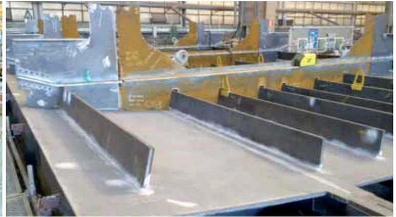
Fig. 16 - Montaggio dei traversi
