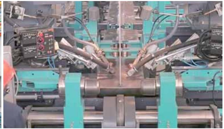
Fig. 24 - Dettaglio teste saldanti e sistemi di guida
