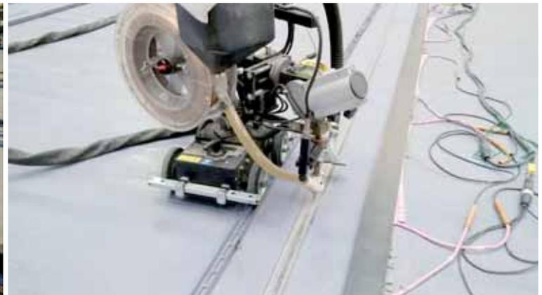
Fig. 21 - Tractor in arco sommerso e termoresistenze
