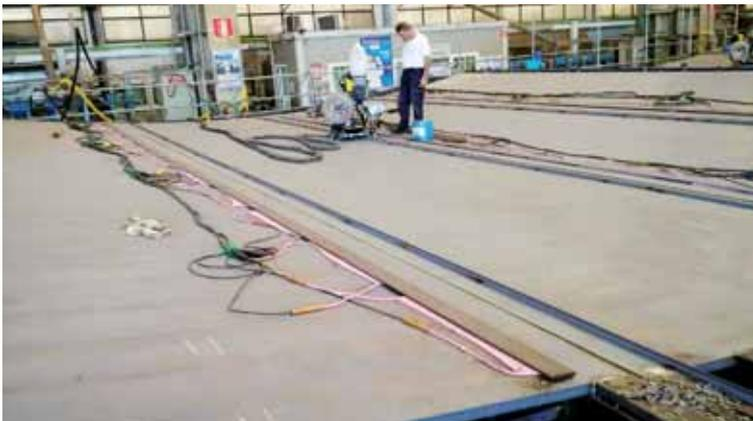
Fig. 20 - Saldatura dei pannelli di spessore 40 mm
