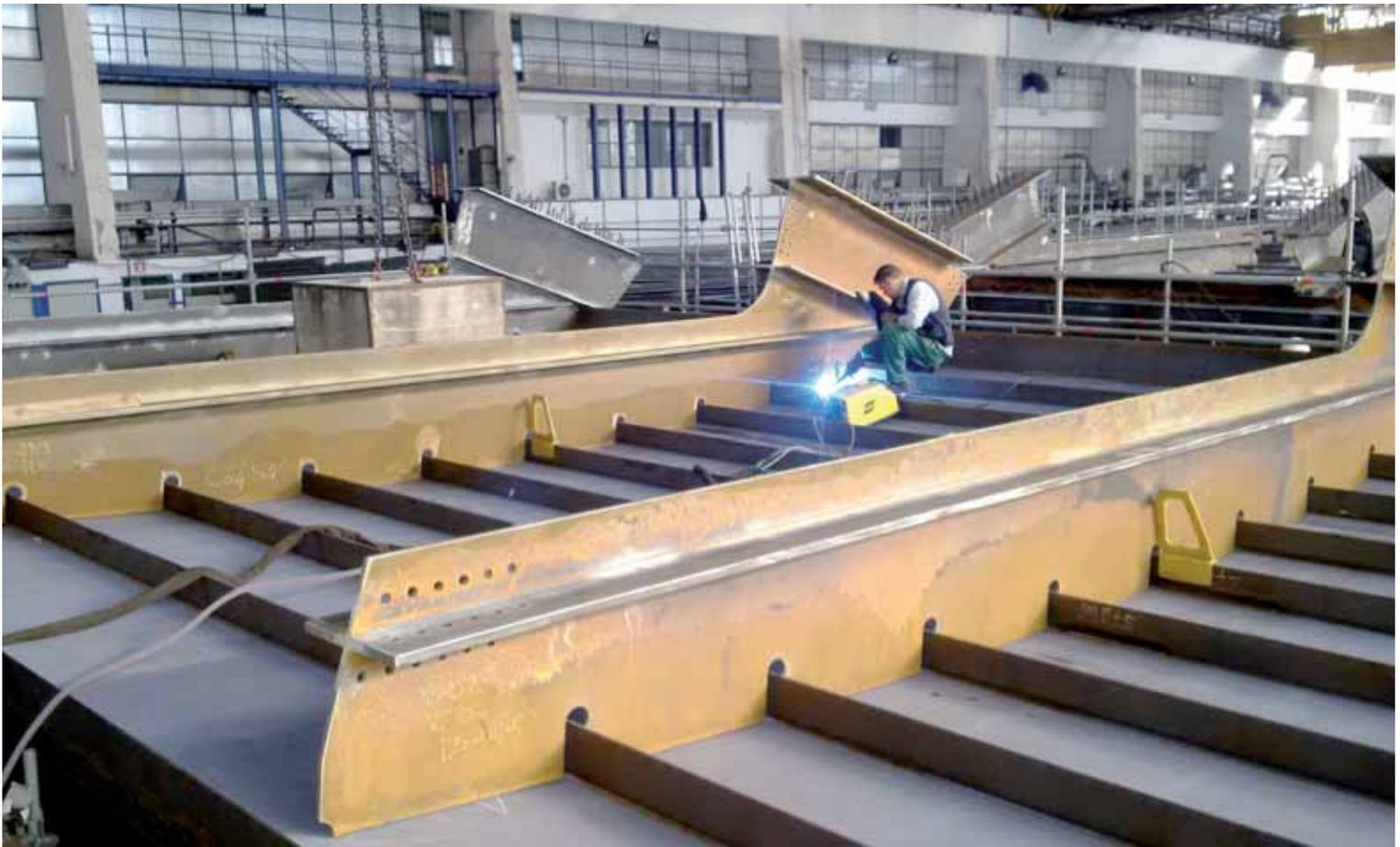
Fig. 17 - Saldatura dei traversi con processo semiautomatico
