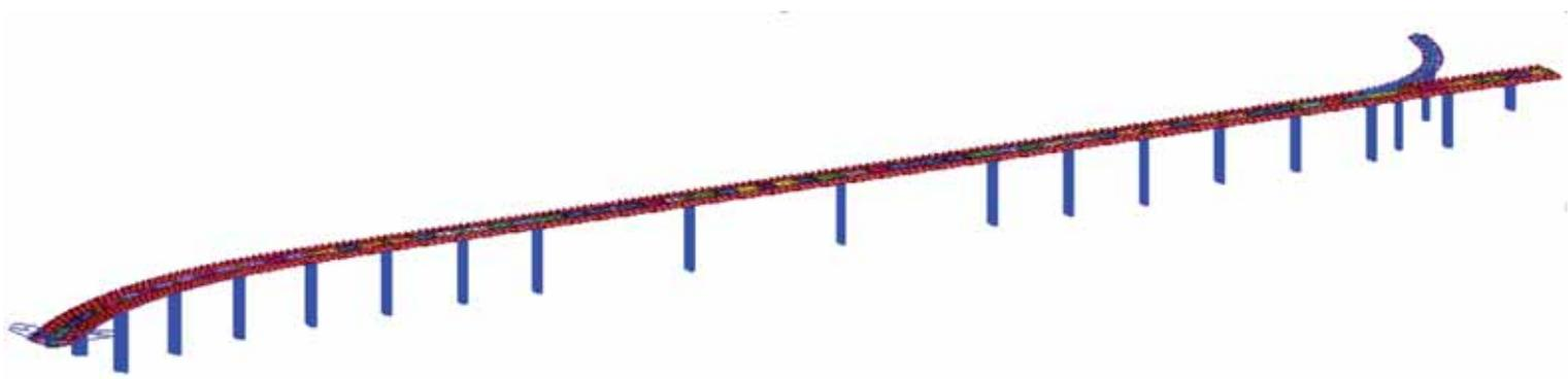
Fig. 14 - Modello di calcolo globale
