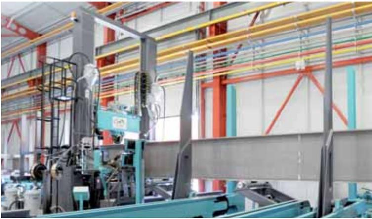
Fig. 23 - Linea di produzione travi
