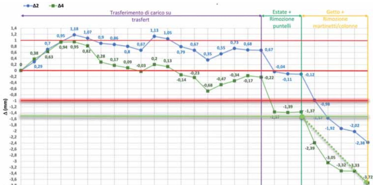
Fig. 16 - Spostamenti monitorati durante il processo di taglio e trasferimento dei carichi.
