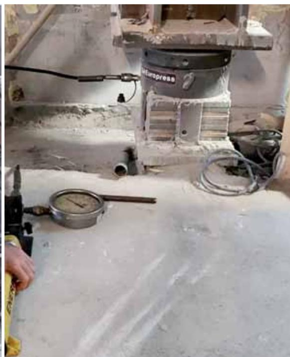
Foto p. Fase di scarico completo martinetti idraulici prima del CHK C
