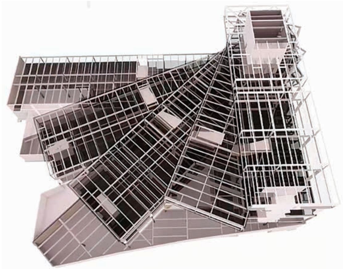
Fig. 19 | Modello 3D digitale della struttura in cui si evince l'orditura dei solai, la griglia strutturale e la posizione delle scale a metà delle stecche (© Silman).
