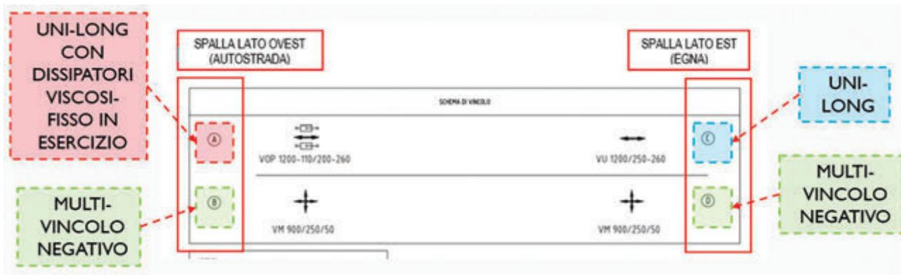
Fig. 13 | Ponte sull'Adige - Schema appoggi e dispositivi di dissipazione
