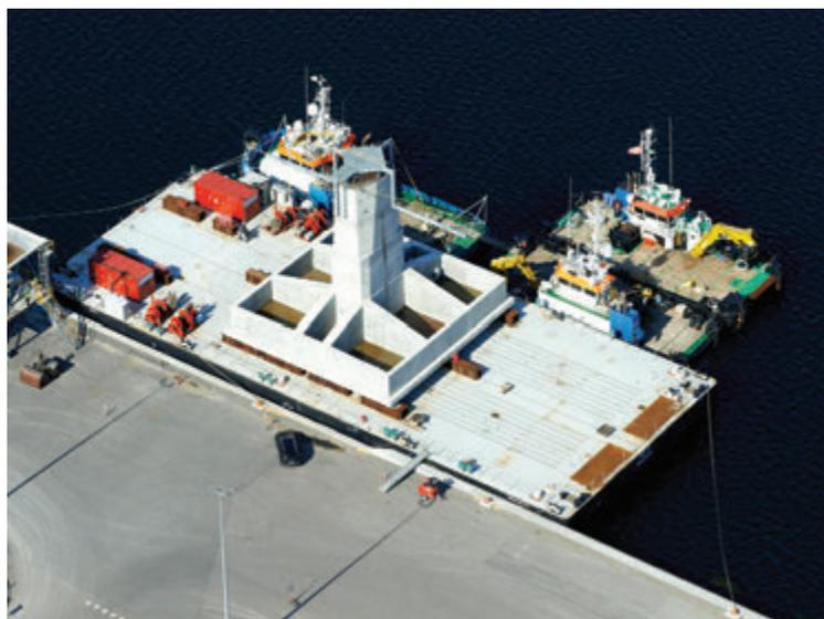
Fig. 2 | Fondazione prefabbricata tipica, su barge di trasporto.
