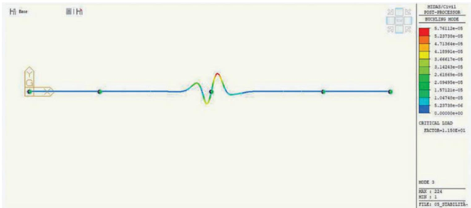
Fig. 6 | Modo critico di instabilità della piattabanda inferiore compressa in corrispondenza della pila P2; si nota l'influenza dell'introduzione dei puntoni di stabilizzazione sulla forma del modo instabile e sul relativo moltiplicatore
