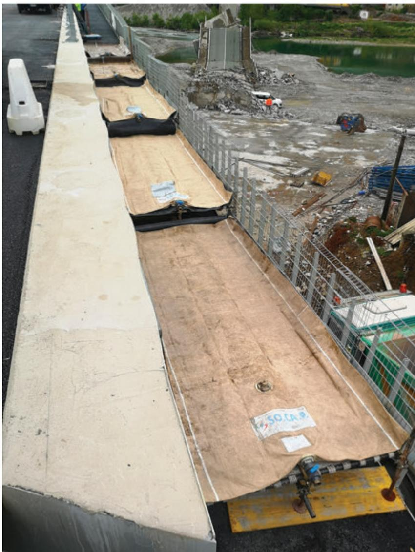
Fig. 14 | I cinque materassi ad acqua utilizzati per le prove del percorso ciclopedonale (21 aprile 2022)
