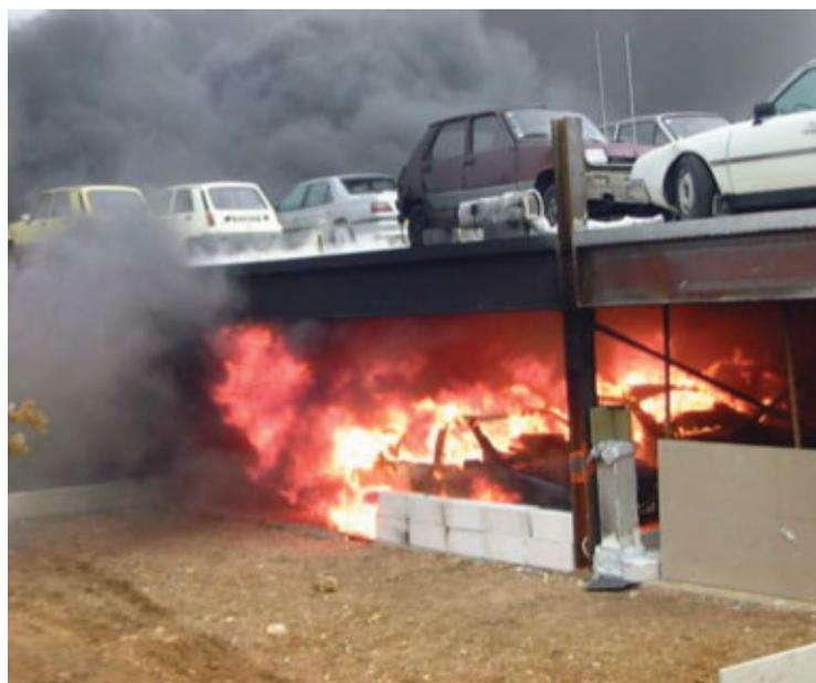
Fig. 13 | Prove sperimentali su intere strutture: incendi in autorimesse ampiamente ventilate
