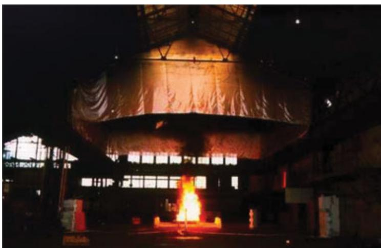
Fig. 11 | Prove sperimentali su intere strutture: incendi di tipo localizzato
