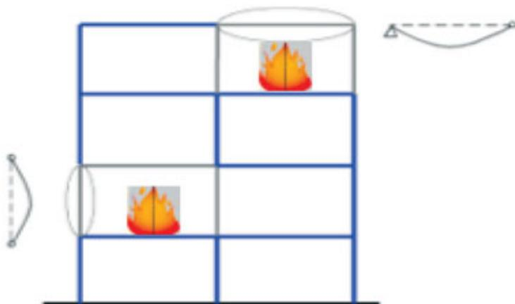
Fig. 4 | Soluzioni conformi: analisi per singoli elementi
