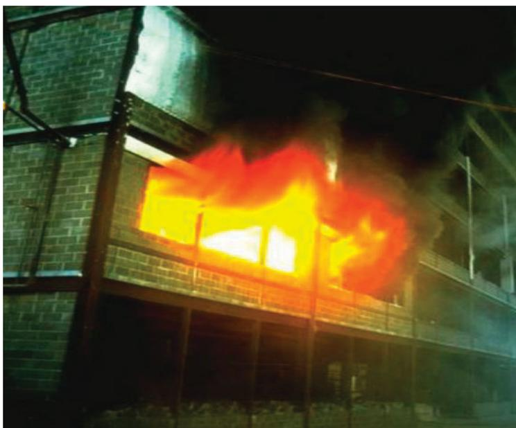
Fig. 12 | Prove sperimentali su intere strutture: incendi di tipo pienamente sviluppato
