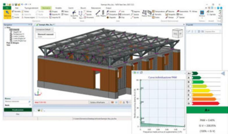
Esempio di calcolo di vulnerabilità per struttura mista muratura-acciaio
