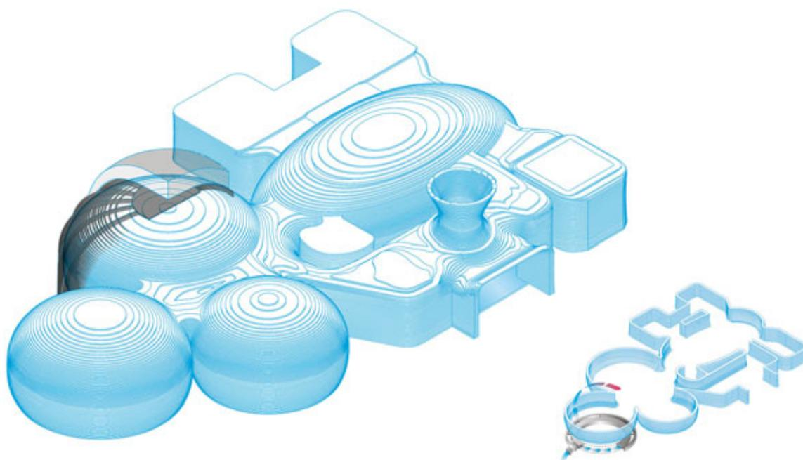
Fig. 5 | Schizzi di progetto e modellazione tridimensionale delle cupole ipogee che creano le sale ellittiche di esposizione, in parte insediata sotto all'edificio storico e in parte sotto il giardino (schizzo® Archivio MCA, schema® Graphic Design di Zup Design)
