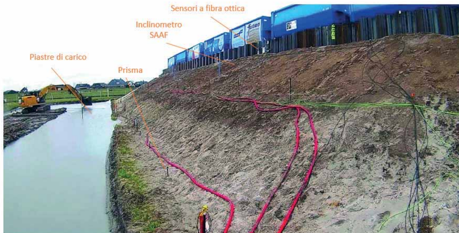
Fig. 7 | Strumentazione sperimentale per il monitoraggio della diga blu
