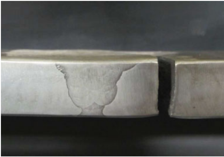
Fig. 15 | Campione di tipo 1: localizzazione della frattura nel materiale base.
