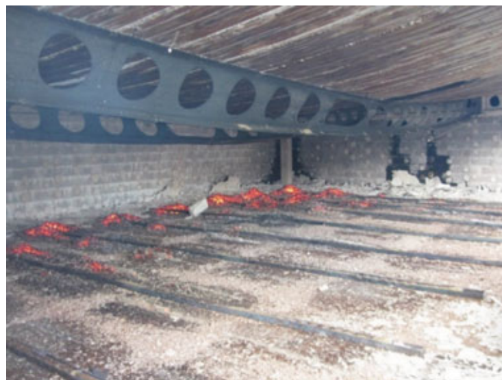
Fig. 15 | Prova di resistenza al fuoco in scala reale di solaio composto acciaio-calcestruzzo con travi perimetrali protette e travi interne alveolari non protette
