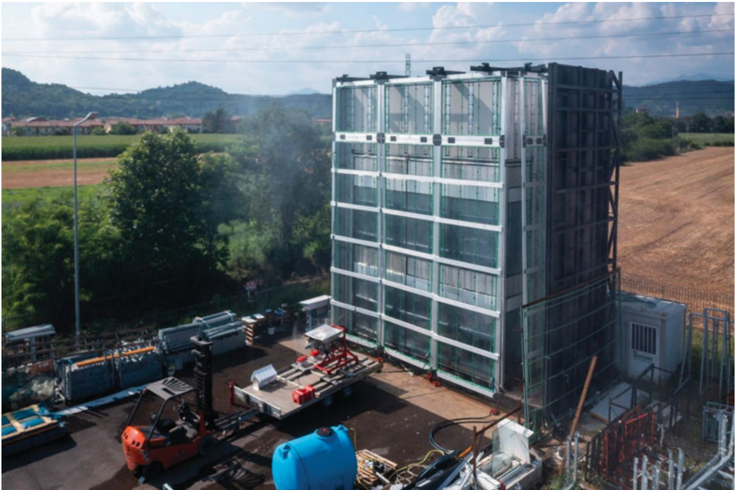
Fig. 25 | PMU Water penetration under dynamic air pressure difference (AAMA 501.1). Il motore d'aereo genera pressioni dinamiche esterne alla facciata mentre viene spruzzata acqua sulla superficie.
