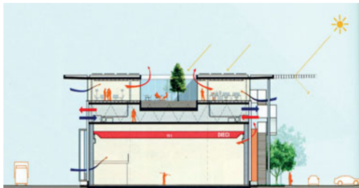
Fig. 14 - Schema del funzionamento bio-climatico © Frigerio Design Group
