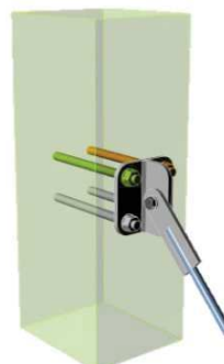
Ancoraggi definiti su una piastra sovrapposta, diversa dalla piastra di base
