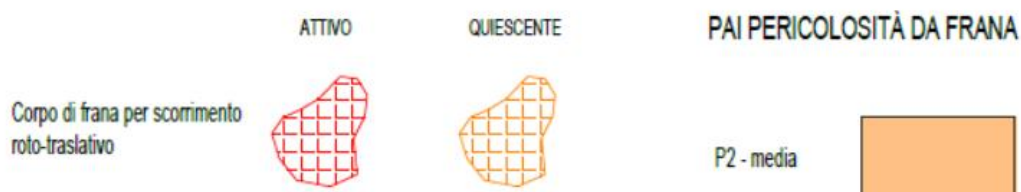
Figura 3.2.1.4 – Stralcio dell’elaborato AMW 3004, riportante i poligoni PAI Calabria 800144800 e 800144700 censiti come zone a franosità superficiale con stato di attività quiescente e pericolosità P2, in cui la carta dei dissesti del PD riconosce degli scorrimenti rototraslativi nel primo caso attivi e nel secondo quiescenti. Per la legenda completa si rimanda all’originale elaborato AMW 3004.
