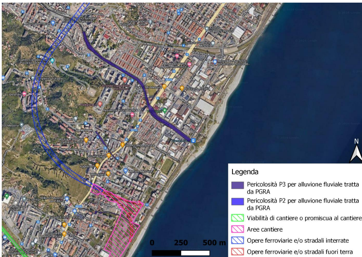
Figura 3.3.2.5 – Intersezioni tra le diverse tipologie di opere di progetto e la pericolosità per alluvione fluviale censita nel PGRA Sicilia.
