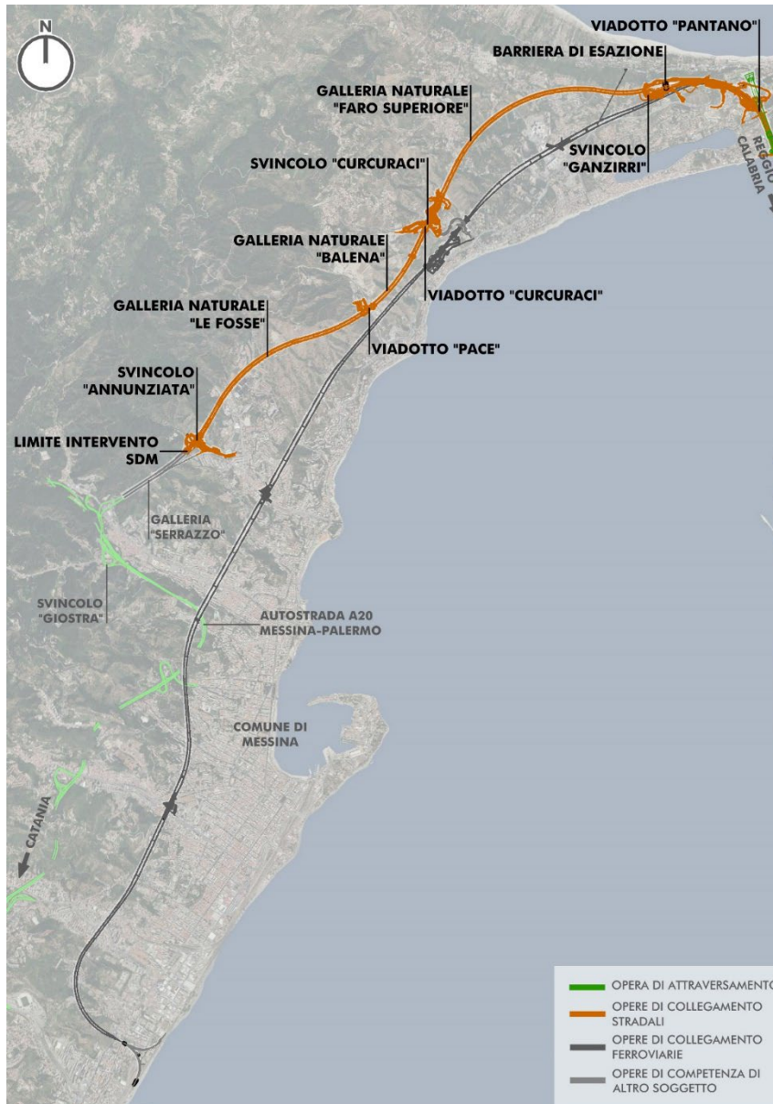
Stralcio planimetrico con principali elementi di progetto costituenti i collegamenti stradali sul versante Sicilia
